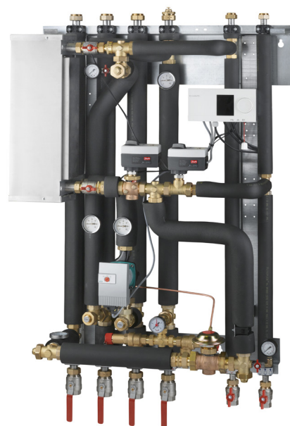
Eksempel: H 228 - automatik 2 kredse. Unitten leveres altid med rørisolering og isoleret kappe
