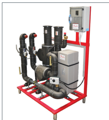
Type DSP 1, MAXI Gulvstillet unit til varme - med svejste rør og loddet pladevarmeveksler.
